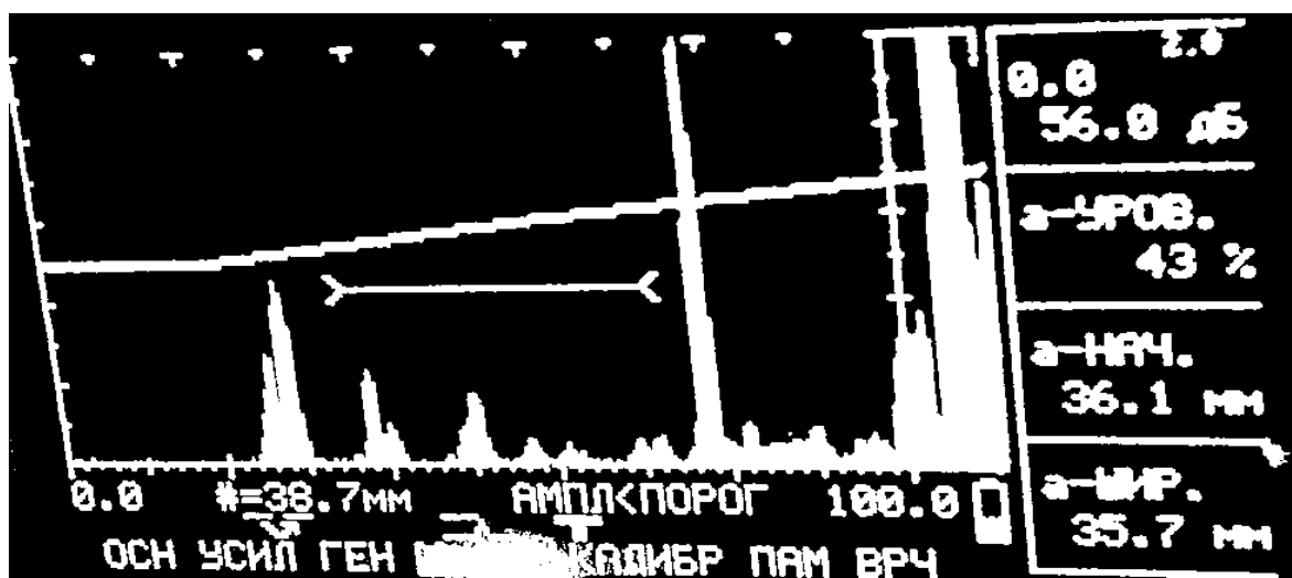
56.0 дБ – усиление сигнала, a-УРОВ., a-НАЧ., a-ШИР. – характеристики строга Рисунок – Показания прибора usm 35 при ультразвуковом исследовании вала эхо-методом
