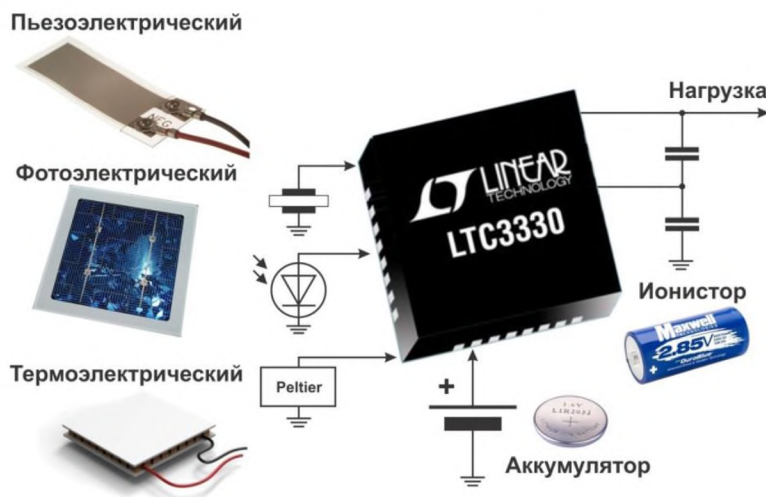
Рисунок 2. – Блок-схема подсистемы электропитания
