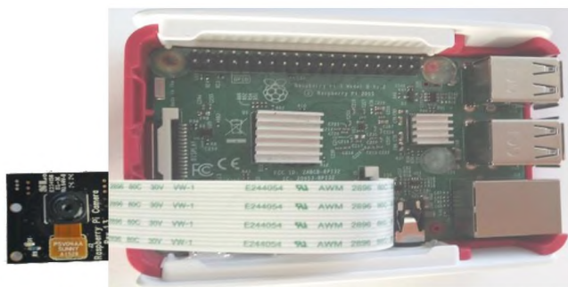
Рисунок 2. – Raspberry Pi 3 с установленными операционной системой Raspbian и библиотекой OpenCV
